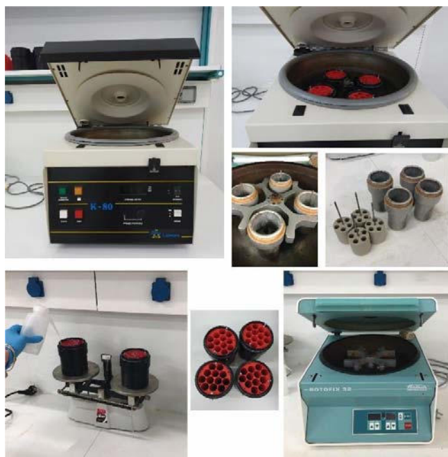
Εικόνα 3 Φυγόκεντροι, υποδοχείς φυγόκεντρου για διαφορετικά μεγέθη σωλήνων και ζυγός ισορροπίας του υγρού παρασκευαστηρίου του Εργαστηρίου Ιστ. Γεωλογίας και Παλαιοντολογίας ΕΚΠΑ
