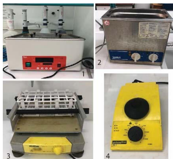
Εικόνα 4 Θερμό λουτρό, λουτρό υπερήχων, συσκευής ανάδευσης με περιδίνηση και συσκευή τροχιακής ανάδευσης, του υγρού παρασκευαστηρίου του Εργαστηρίου Ιστ. Γεωλογίας και Παλαιοντολογίας ΕΚΠΑ
