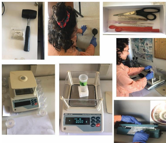
Εικόνα 7 Δειγματοληψία ιζήματος για παλυнологική χημική επεξεργασία στο Εργαστήριο Ιστ. Γεωλογίας και Παλαιοντολογίας ΕΚΠΑ
